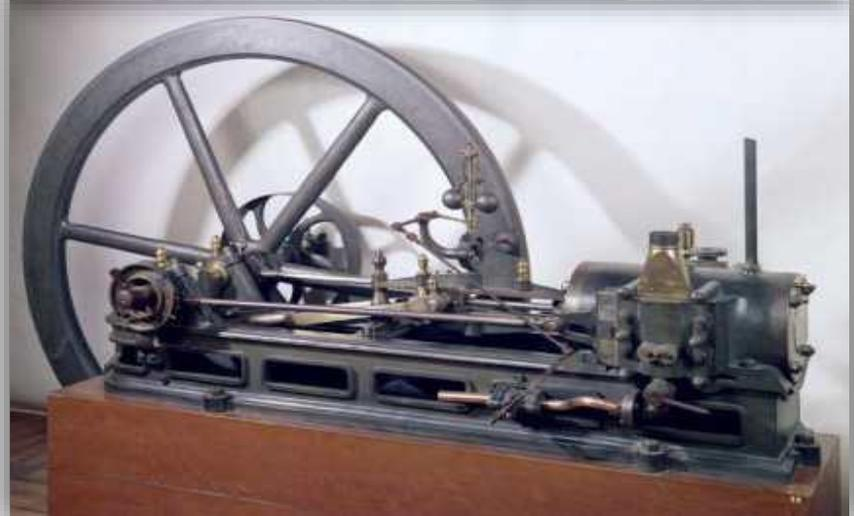
Через 7 лет уже в 1867 году немецкий инженер Николаус Отто создал 4-х-тактный двигатель с воспламенением от сжатия. Этот двигатель имел мощность около 2 л.с., с числом оборотов 150 оборотов/мин. Двигатель мощностью 10 л.с. имел КПД 17% , массу 4600 кг нашел широкое применение. Всего таких двигателей было выпущено более 6 тыс. 1880 г. мощность двигателя была доведена до 100 л.с.
