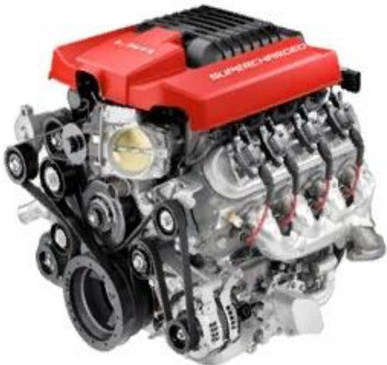
V-образные - цилиндры расположены один напротив другого под углом от 10 до 120. Мотор состоит из двух блоков цилиндров, немного смещённых относительно друг друга и соединённых общим коленчатым валом. V-образные двигатели имеют только чётное количество цилиндров. Как правило, такие двигатели более компактные и сбалансированные, чем рядные, и обеспечивают больше мощности.
