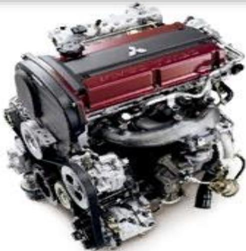
Цилиндры расположены на одной линии, а их поршни вращают один коленчатый вал. Такие двигатели более простые по конструкции, надёжные и удобные в обслуживании, чем V-образные. Могут иметь как чётное (2, 4, 6 или 8), так и нечётное (3 или 5) количество цилиндров.
